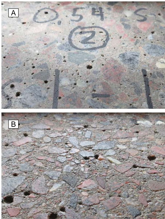
Figur 5. Ytan på provkroppar med vct 0,54 efter avslutat försök. Provkroppen i bild A utsattes enbart för frysning medan provkroppen i bild B utsattes för urlakning, frysning och nötning.
